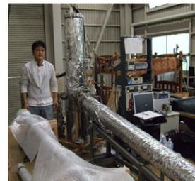
図3. 断熱管テストベンチ
