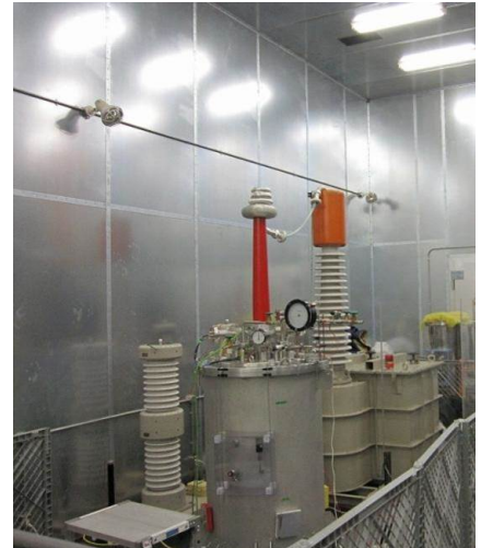
図：シールドルームに置かれた高電圧印加試験用クライオスタット
