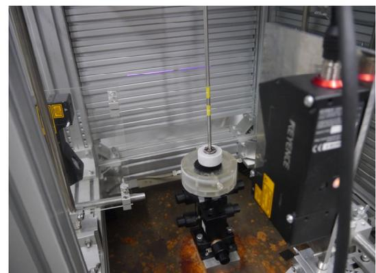
図2 超電導磁気支持型回転装置
