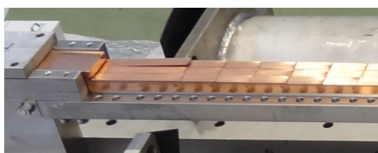
図3 導体サンプルの機械的接合部(接合前)
