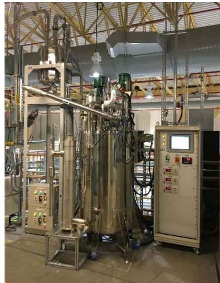
図 設置完了後：左：気液分離器、
