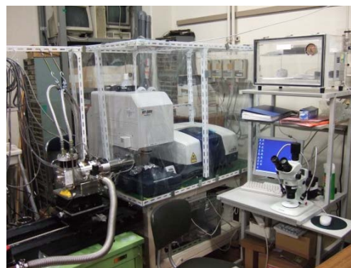
図1 低温赤外顕微分光装置. 0.1 ~ 1.5 eV の赤外光領域で微小試料(200 × 200 μm 2 )の反射分光測定が4 ~ 300 K で可能
