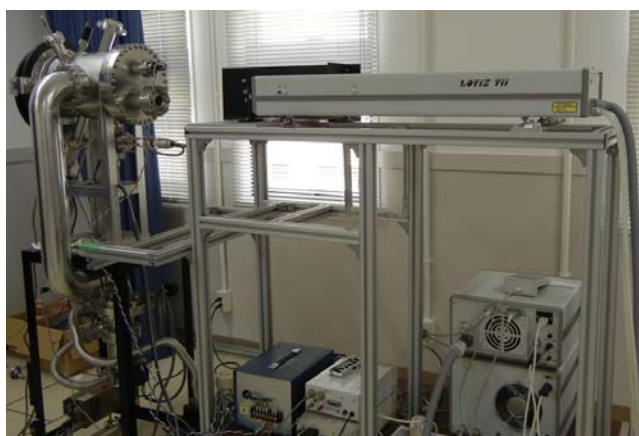
図1 薄膜作製装置 (YAGレーザーとチャンバー)
