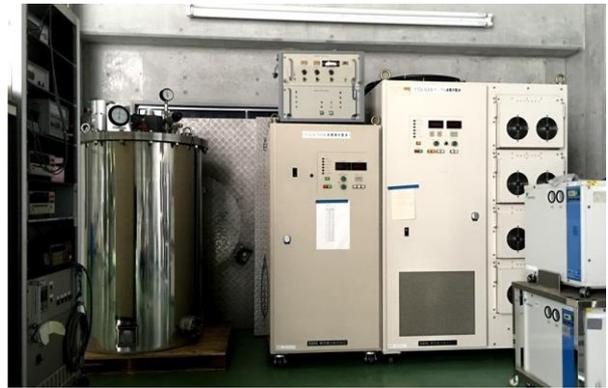
図：電流輸送特性評価装置。
