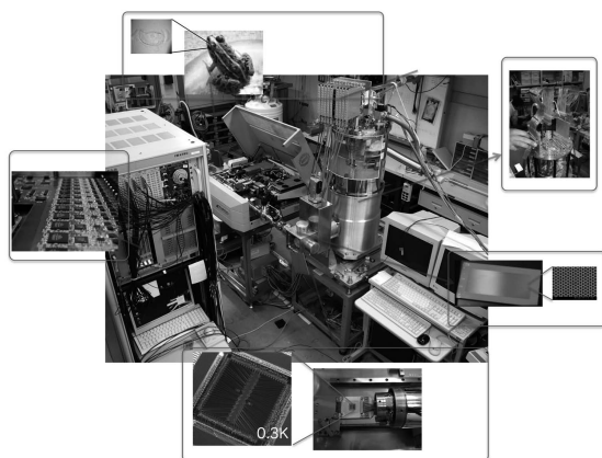
図6 伝導検出器を搭載した生体分子用の質量分析装置
