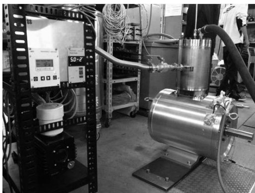
図5 NEDOプロで開発した20 kW級HTS-ISM プロトタイプ機の外観写真[6]
