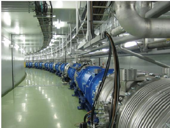
図 1. 超伝導ビームライン磁石システム
