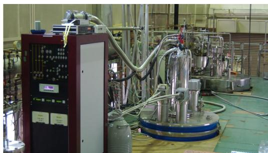
図1 HM室の様子。中心の青い装置が28 T無冷媒ハイブリッドマグネット、奥の銀色は30 Tハイブリッドマグネット。手前左の赤茶色枠ラックは希釈冷凍機のカスタムガスハンドリングシステム。
