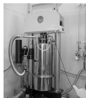
図 高圧下輸送現象測定装置の写真
