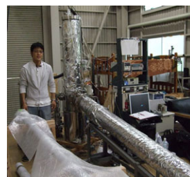
図3. 断熱管テストベンチ
