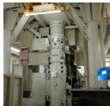
図4. 多元解析が可能な超高压電子顕微鏡
