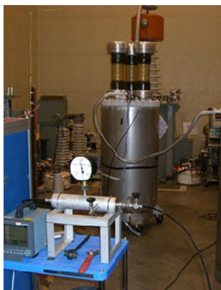
図3 モデルケーブルの電気絶縁試験装置 (上図：モデルケーブル、下図：試験用クライオスタット)
