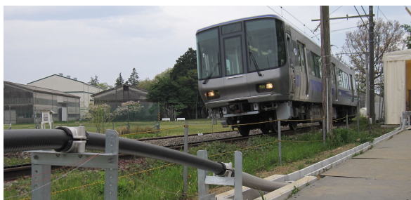
超電導ケーブルを用いた車両走行試験
