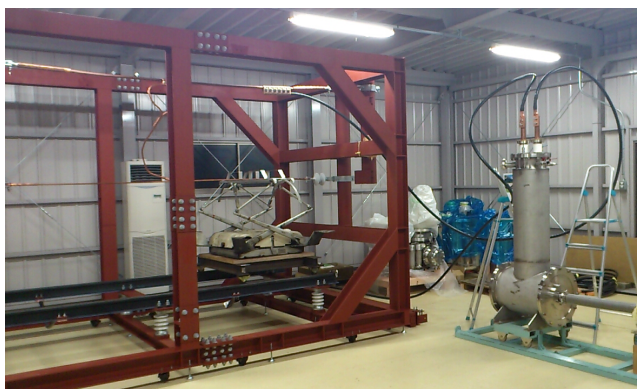
鉄道用超電導ケーブル実験室 (模擬架線、パンタグラフ、鉄道レール、電流端末)
