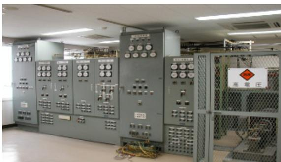
図4 模擬電力系統試験装置(6kVA/220V/3300V送電線模擬)
