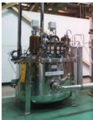
図3 ブレイトン冷凍システム循環ポンプユニット
