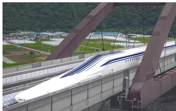
図5 新型車両L0系の先頭形状
