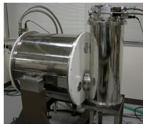
図1 10 T級超電導マグネットと4 K級L字型伝導冷却試験装置
