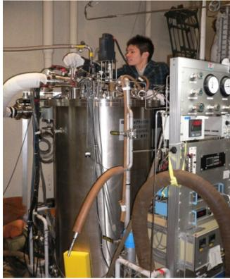
図6 加圧超流動ヘリウム実験槽
